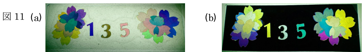
図 11. 色文字暗号板 : a は偏光板が平行の場合、b は偏光板が直交している場合
