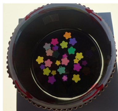
図 16. クリアケースの蓋の偏光板の偏光方向が底の偏光板の方向と直交した場合
