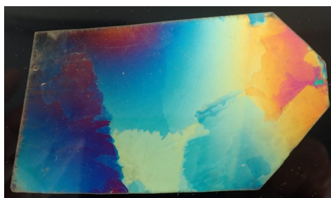
図 6. 雲母板（層構造になっているのが分かる）
