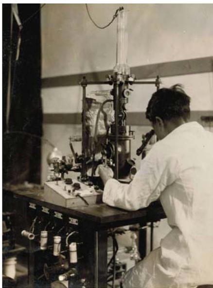
電子回折装置で実験中 (1943年)
